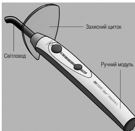
Джерелом світла є високоефективний світлодіод (LED). На відміну від галогенових ламп випромінюване світло має довжину хвилі 430–480 нм, що відповідає діапазону, наприклад, для виробів на основі камфорорхінону.
